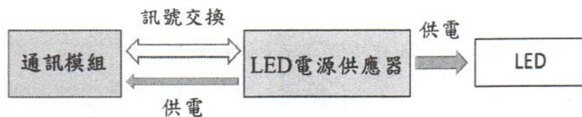
圖2 電-通分離設計示意圖
