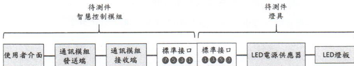
圖5 待測件智慧控制模組對接待測件燈具之測試架構
