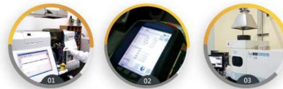
01 火焰式原子吸收光譜儀-AAS    02 X射線螢光光譜儀-XRF
